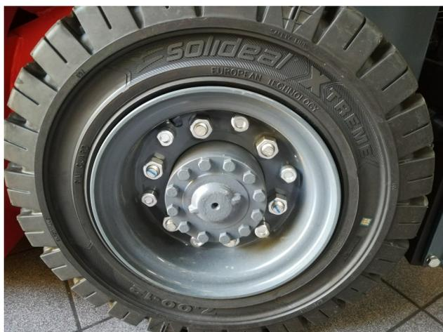
El operario de la carretilla en su revisión diaria deberá prestar atención al estado de las ruedas, ¿mantienen dibujo o se han convertido en completamente lisas? ¿Presentan fisuras o cortes?
