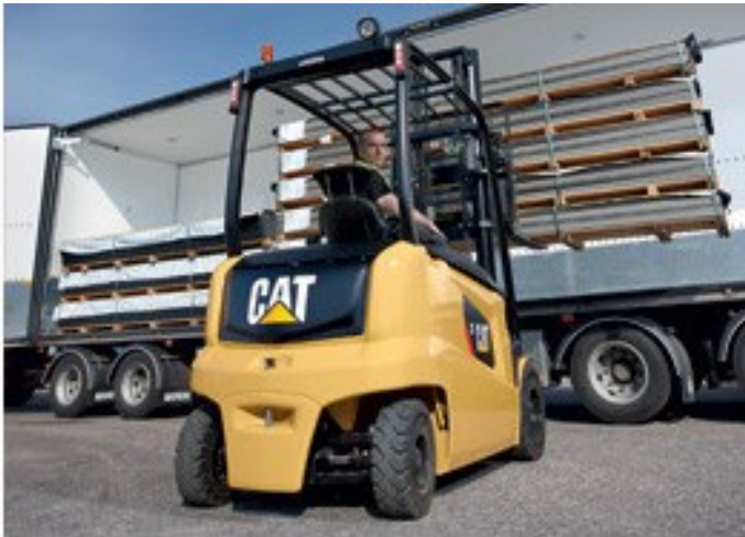
Carretilla frontal eléctrica Caterpillar trabajando en el exterior.
